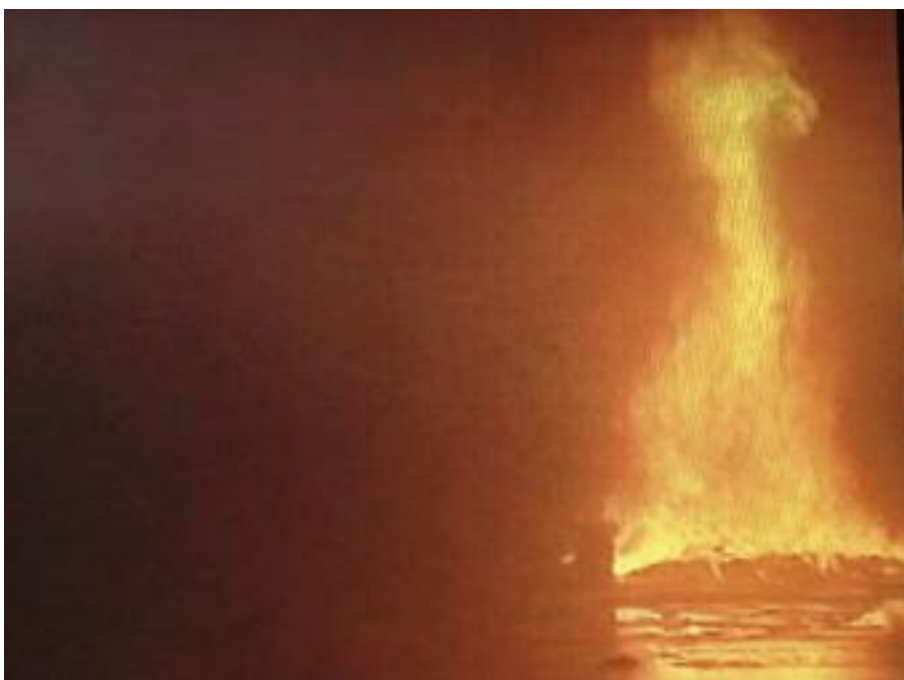
Figura 3 - Prove d'incendio senza SEFC attivo
