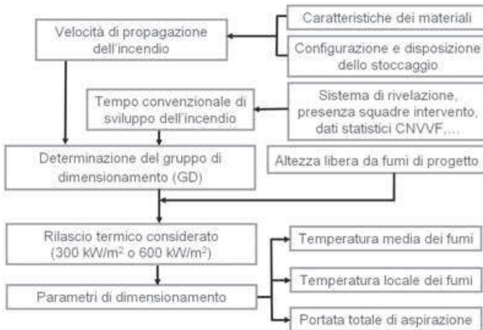
**Figura 10 – SCHEMA RIASSUNTIVO DEL PROCESSO DI DIMENSIONAMENTO DI UN SEFFC**
