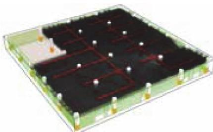
**Figura 4 – SUPERFICIE COMMERCIALE DOTATA DI VENTILAZIONE NATURALE** pari a 1/40. Diffusione dei fumi dopo circa 8 minuti dall'inizio dell'incendio
